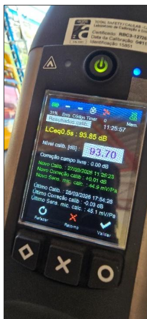
Figura 27: Resultado da calibração do sonômetro.
