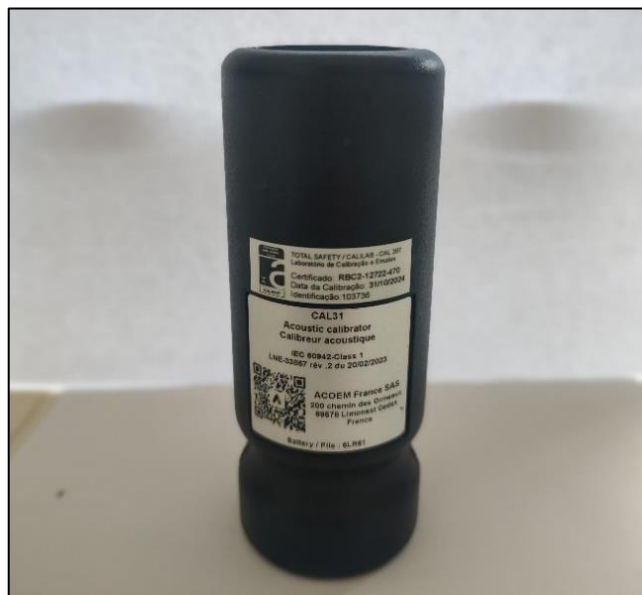
Figura 16: Calibrador acústico modelo CAL31, marca 01dB.
